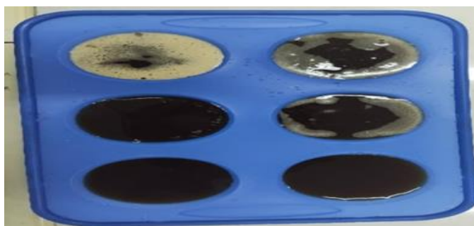
شکل ۳: ساخت فیلم نانوکامپوزیت آنتی باکتریال با روش قالب گیری
